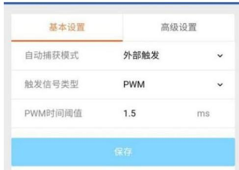
12. 断开从相机 WiFi，连接主相机 WiFi（WiFi 账号：相机型号-相机序列号，WiFi 密码为 yusense2020）；连接成功后使用浏览器访问 192.168.18.1 网址，进入主相机设置界面。
