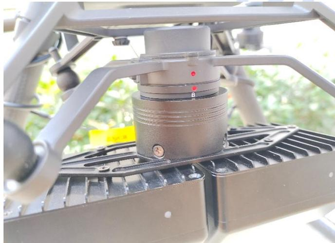
8. 使用 DLS 配线连接电源配线与 DLS 后侧 CAM 接口；并使用魔术贴将 DLS 配线固定在无人机脚架上；（注：DLS 配线为相机产品的标配线缆，非 skyport 套件标配组件）
