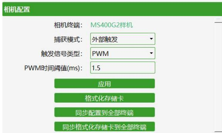
图 3-11 PWM 触发操作界面
