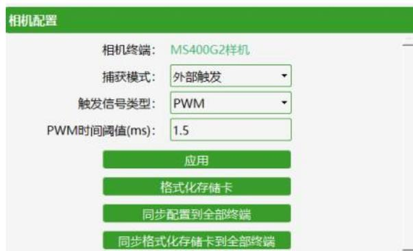
图 53 PWM 触发操作界面
